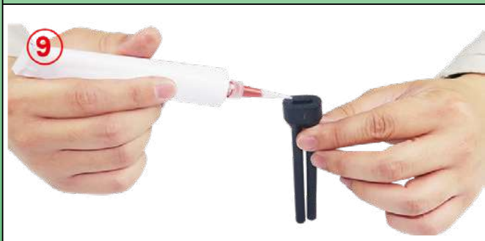
9: Versare la resina siliconica (RTV) nel foro d'ingresso dei fili della guaina siliconica.
